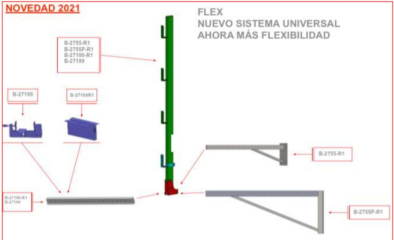
**FLEX** barandilla protección UNE EN 13374 con postes para fijación a canto, a muro, a losa, a suelo, a viga metálica, viga de madera, a techo, a fachada, para plataformas...por favor visite nuestra web para ver la gama completa:
